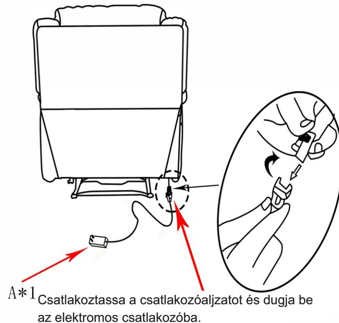
A\*1 Csatlakoztassa a csatlakozóaljzatot és dugja be az elektromos csatlakozóba.
