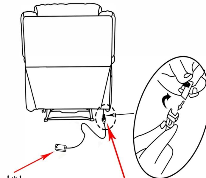
A\*1 Pripojte napájací zdroj a zapojte ho do zásuvky (elektrického zdroja)
