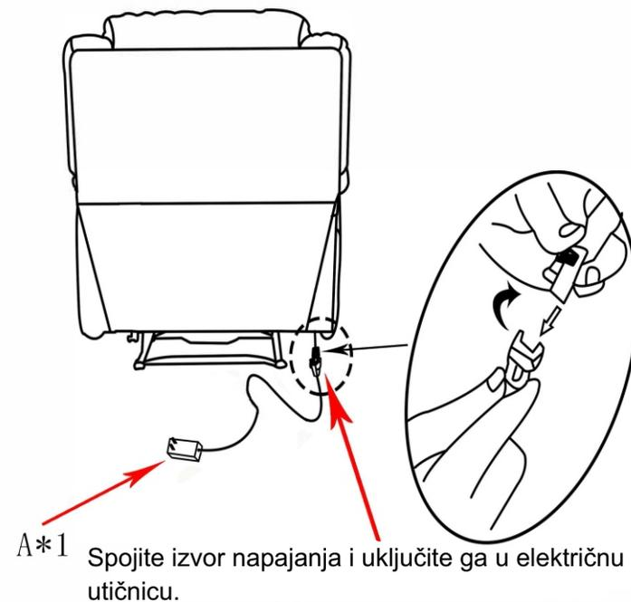
A\*1 Spojite izvor napajanja i uključite ga u električnu utičnicu.
